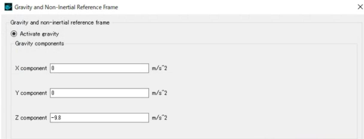
図 4.4: 地球の重力加速度  $9.8 \text{ m/s}^2$  を設定した。重力に対して負の方向を  $z$  軸の正方向としているため  $9.8 \text{ m/s}^2$  と設定した。
