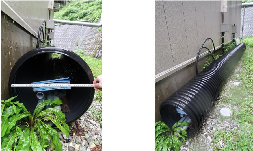
図 2.7: KAGRA 敷地内で放置されているパイプの写真。このパイプと同様のパイプが KAGRA 内に設置され、地下水を排出している。内径は左写真にあるように 0.4m である。パイプ外部は蛇腹形状であり凹凸があるが、パイプ内部では外部ほど凹凸はない。
