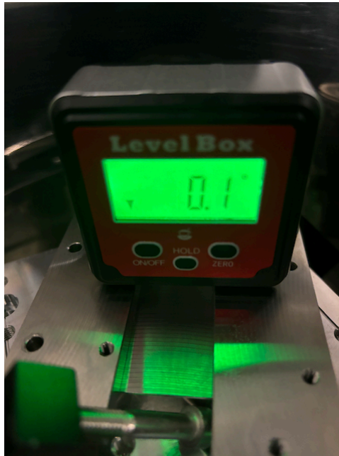
図 8.2.1: 真空槽内の水平計
