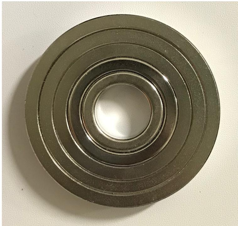
図 6: 使用したリング型のネオジウム磁石
