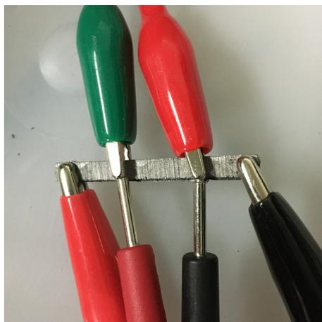
図 4.8: 四端子法によるグラファイトの電気抵抗率の測定
