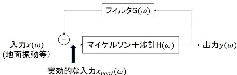
図 3.1: フィードバック制御
