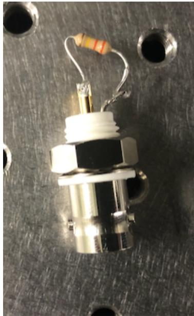
図 4.6 ジョンソンノイズの測定に用いる抵抗。inputBNC へ繋ぐ。
