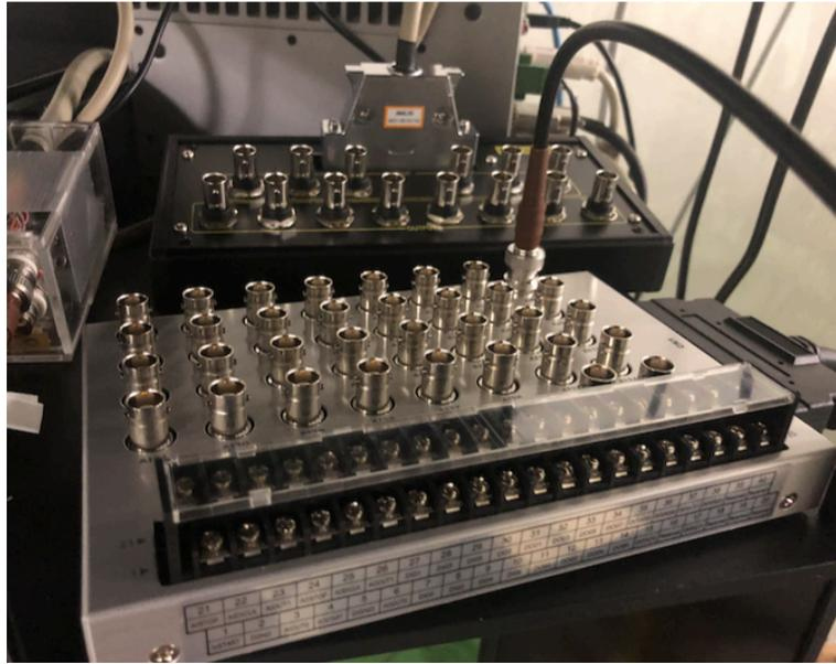
図 4.8 測定に用いる ADC。回路の信号をデジタル信号にする。
